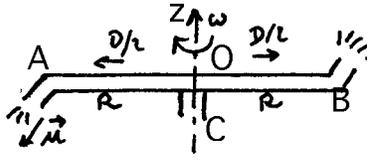
Un tourniquet est formé de deux branches de rayon  $R$ , éjectant chacune, à une vitesse relative  $u$  orthoradiale vers l'arrière, de l'eau avec un débit massique  $D/2$ . Il est alimenté par une canalisation verticale fixe amenant le débit total  $D$ .
