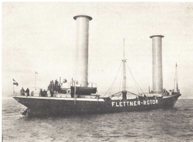
Fig. 1. — Le Buckau, bateau à vent muni des deux rotors du système Flettner.
